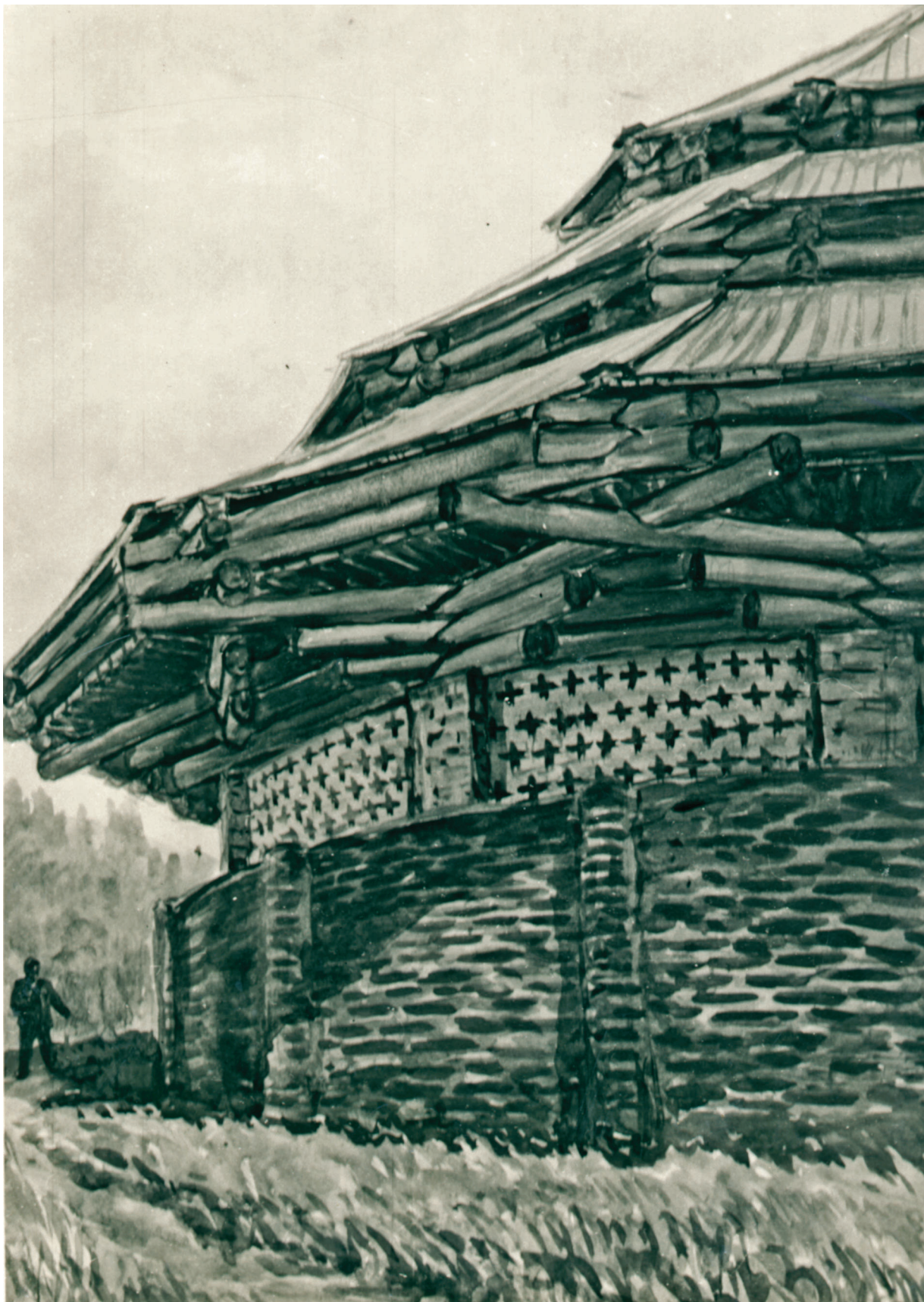
Ил. 61. Вариант деревянного шатра со ступенчатой трехъярусной дощатой кровлей без внешних опорных столбов над консервированными руинами Смоленской ротонды [1954 г.]. Ч/б фото рисунка. 19 × 13,5 см (ГНИМА. Ф. Р-ХIV. Оп. 34. Д. 61. Л. 5)
