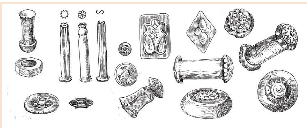
Рис. 50. Инструменты для штамповки киргизского ювелира: формы-калып для изготовления узорных пластин на сбрую; чеканы тешкич для нанесения узоров на женские украшения и сбрую (по: Иванов, Махова, 1968).
