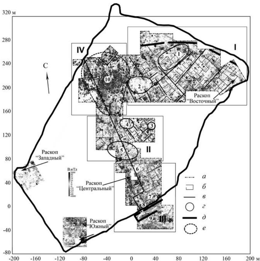
Рис. 1. Белинское. Карта аномалий магнитного поля на участках, обследованных 2007–2009 гг. в пределах предполагаемого контура городских стен, и интерпретационный план центральной и восточной частей городища. Шаг изолиний 4 нТл
